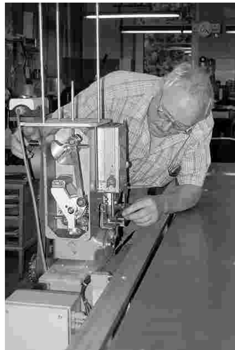
Mitarbeiter Josef Schümmer bei Instandsetzungsarbeiten an einer Dohle-Industrie-Nähmaschine. Fotos: Paul Santosi
