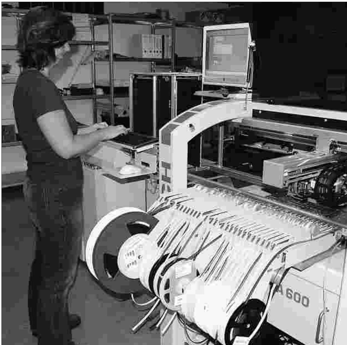
Mitarbeiterin Karin Seidel an einer vollautomatischen SMD-Linie zur Herstellung miniaturisierter Elektronikteile. Fotos: Paul Santosi
