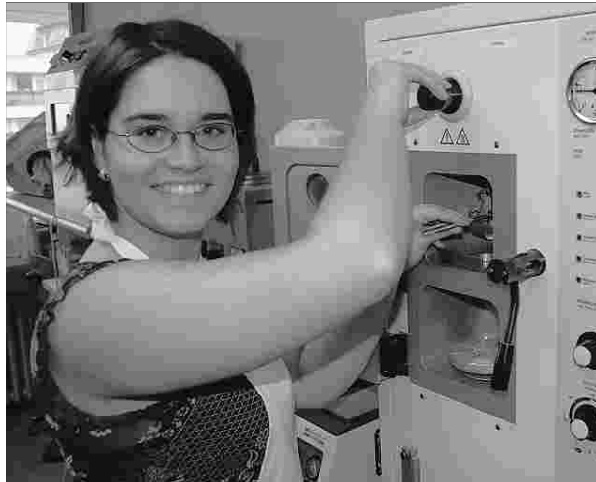
Hier ist Präzisionsarbeit gefragt: Dentaltechnikerin Nicole Cüpper am Titan-Gießofen.
