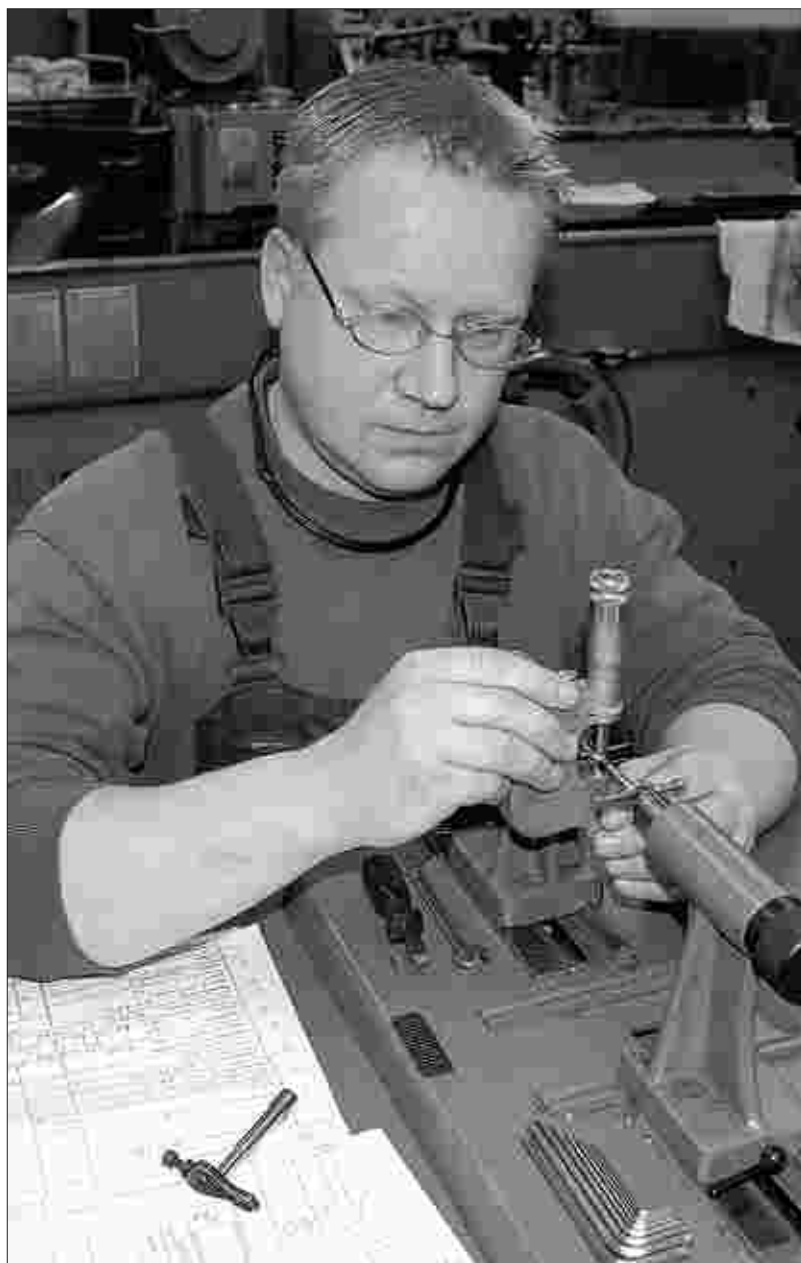
Mitarbeiter Thomas Ragutt bei einer Zwischenmessung beim Gewindeschleifen. Fotos: Paul Santosi
