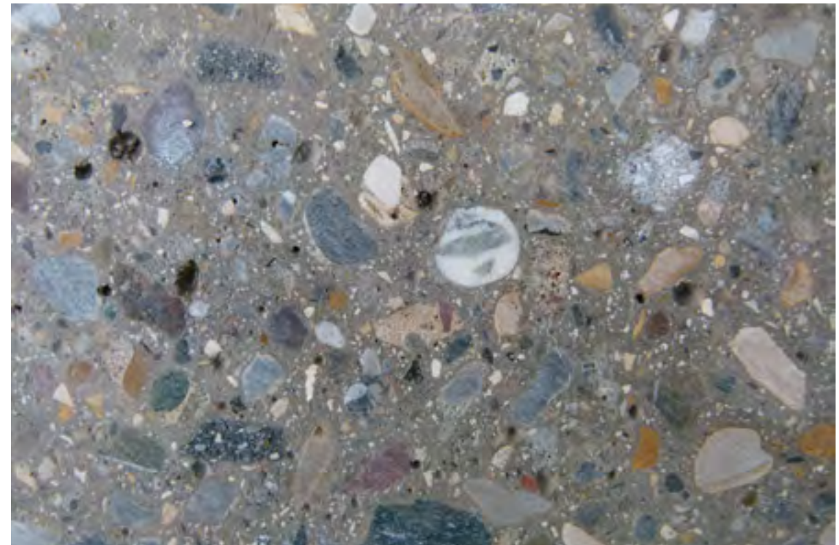
Abb. 11 - RC-Beton kaum von konventionellem Beton zu unterscheiden, spart aber große Mengen Rohstoffe ein.
